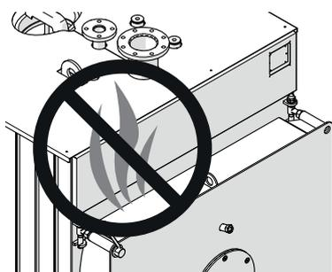
Проверить правильную регулировку по длине и убедиться, что дверца при нажатии вручную до упорного бурта возвращается обратно, оставаясь приоткрытой для обеспечения герметичности со стороны шарнирных петель.
